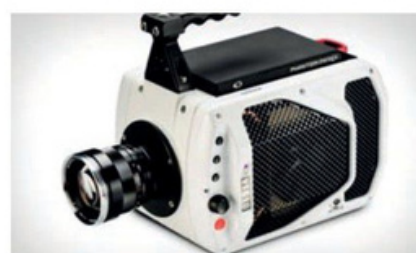
Kamera szybkoobrotowa Phantom v1610 do wizyjnych pomiarów procesów szybkozmiennych
