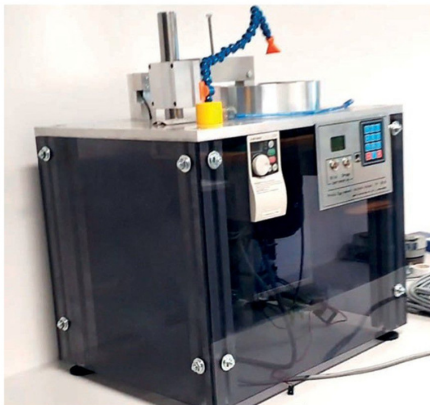
Autorski trybotester do pomiaru zużycia i badania zjawisk tarcia
